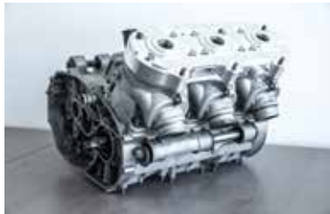
現在制作中の3気筒エンジン。チータのシリンダーを3連装する。クランクは圧入式なので1気筒分を追加するだけだ
