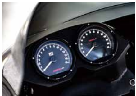
エンジンが違ふから R3 のメーターは使用できない。タコとスピードは KOSO のアナログメーターに変更されている
