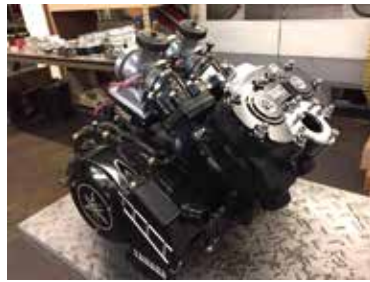
R3-Zに搭載されているエンジン。チータカブのシリンダーを使い、ヘッドやカバー類はオリジナルのアルミ削り出しだ
