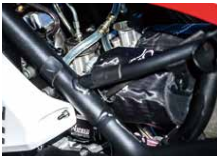
サブフレームはメインフレームにこんな感じで接合される。無加工だとは作られない。まるで純正のよう
