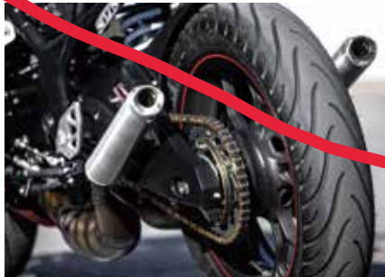
443 の排気量に合わせた容量を確保したチャンバー。スタートでの楽しさを追求した特性になっている。
