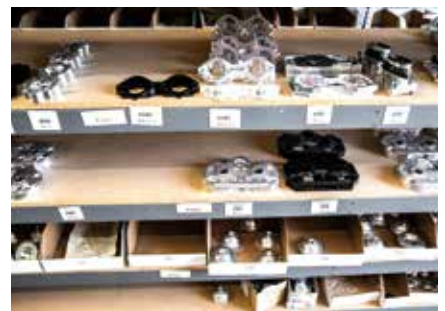
RZ350Rなどに使用するシリンダーヘッド。カラーや形状などで色々なタイプがある。燃焼室のドームは交換式だ
