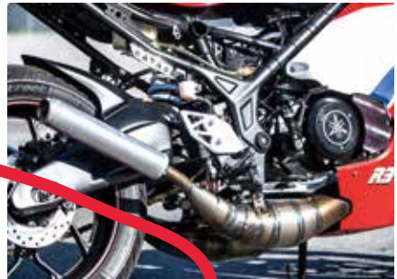
キャブはケイロ DWK39 をと連装。フロントボールはオランダ製のフロント出しで容量が大きく安定した性能を確保する。
