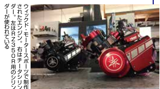
現在制作中の3気筒エンジン。チータのシリンダーを3連装する。クランクは圧入式なので1気筒分を追加するだけだ
