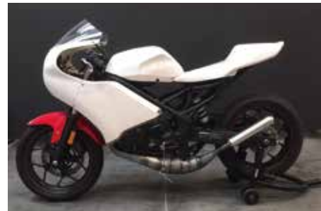
製作途中のスナップ。エンジンや吸排気系が搭載され、外装の取り付けが終了したところ。イメージに忠実に仕上がっていることが分かる
