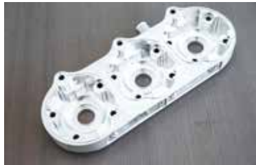
3気筒用のシリンダーヘッドも自社の機械を使って製作済み。マシニングを持っている強みを最大限に生かしている
