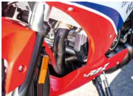
カウルの隙間からサブフレームとフロント側のエンジンハンガーが見える。サブフレームは分割式で整備性も良好だ
