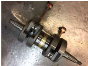
ウィックド・モータースポーツ製のクランク。7mmストロークアップで115mmのコンロッド。高負荷に耐えられるベアリングを使用
